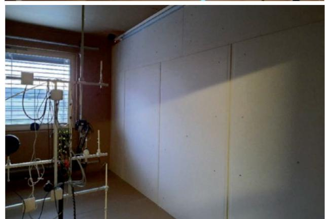
Raumluftmessungen in der Fassadenprüfbox der AEE INTEC im Rahmen des Forschungsprojektes ‚Clay to stay‘ zur Untersuchung der Schadstoffaufnahme von Lehmplatten. Fotos ©: Ute Muñoz-Czerny
