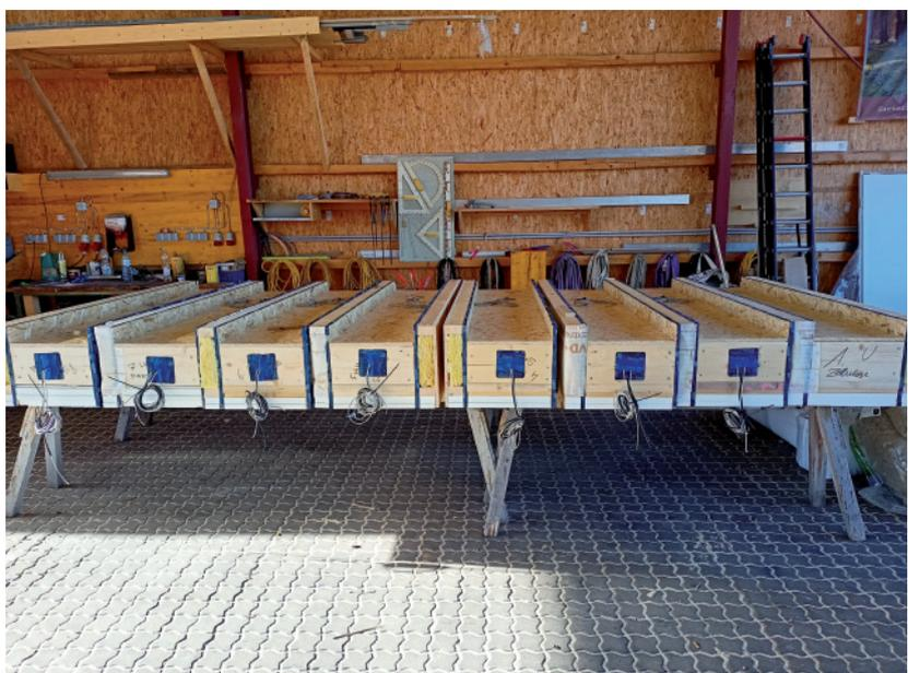
Abb. 3: Wandmodule vor dem Einbau in den Freiluftprüfstand.
