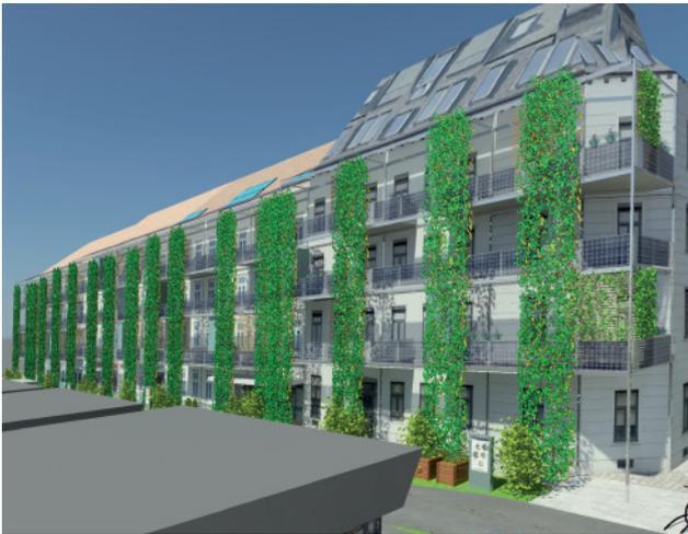
Abb. 4: Häuserzeile Rosaliagasse 1,3, 5,7. Rankregal mit Balkonen, Photovoltaik-elemente und Vertikalbegrünung. (Visualisierung: EIGENSINN)
